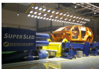
衝突安全試験に使用されるFITPの加速式スレッド試験機。 同社つくばテクニカルセンター 出所：同社ウェブサイト
