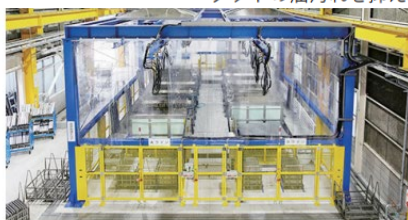
自社工場設備 自動制御のクレーンにより、フィルター洗浄・乾燥を自動化
