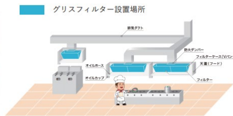
グリスフィルター 飲食店などの厨房の排気ダクトの入口部に設置されるフィルター。ダクトの油汚れを抑え、火災を抑制。
